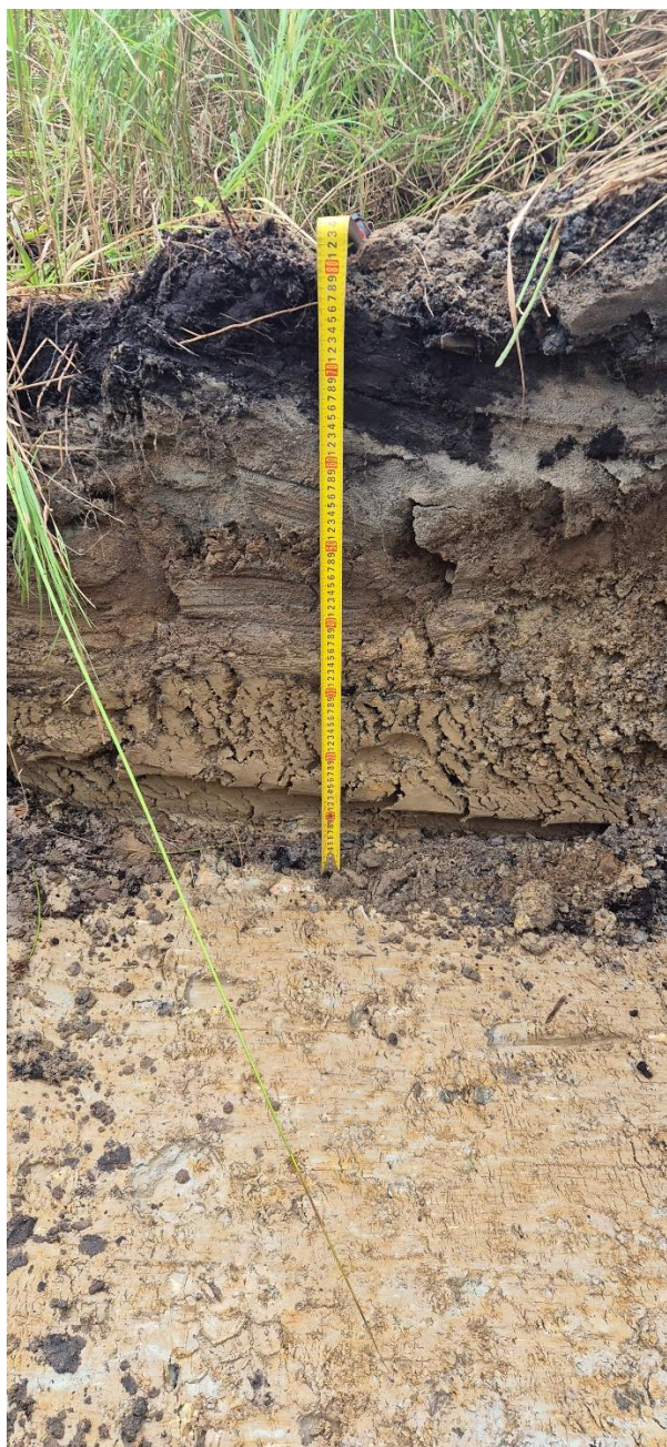
Foto 5.3. Katend, millele järgneb koheselt savimoreenne lamam (K-25). (Foto: Sven Siir, 28.08.2025, 58°11'07.2"N 24°44'25.4"E).
